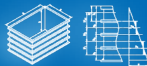
Rektangulær tank med ring forstærkninger
